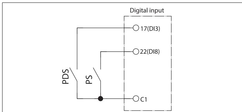
Пример схемы подключения на цифровые входы потенциальный контакт
